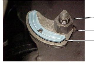
FACTORY UPPER CONTROL ARM TO FRAME ALIGNMENT ADJUSTING BOLT.
