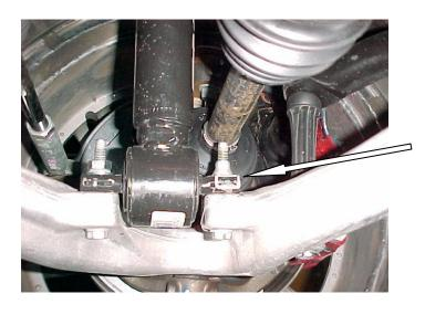
LOWER STRUT MOUNT SITTING ON <u>TOP</u> OF THE FACTORY LOWER CONTROL ARM. STRUT MOUNT.
