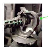
ANTILOCK BRAKE WIRE UNCLIPPED FROM THE TOP OF THE UPPER CONTROL ARM.
