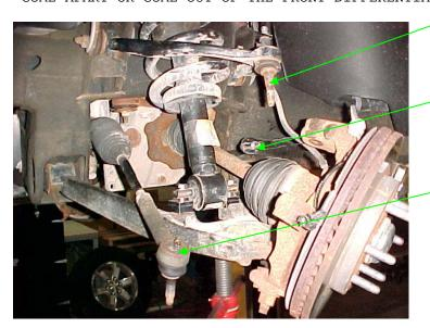
UPPER BALL JOINT REMOVED FROM SPINDLE.
