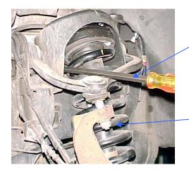
LARGE BAR PUSHING DOWN ON THE UPPER CONTROL ARM SO THE UPPER BALL JOINT CAN BE REINSTALLED.
